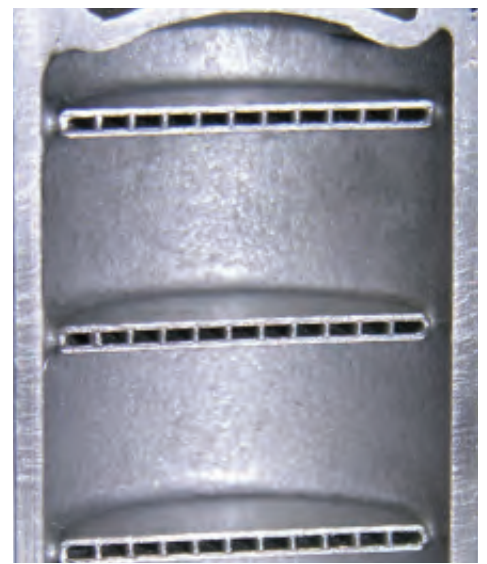
Sección transversal de colector para intercambiador de calor de microcanal
