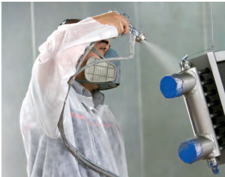
Solución de aplicación mediante pulverización ES 2 Insitu®
