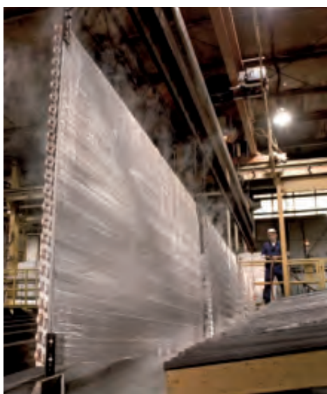
Proceso térmico de limpieza alcalina para eliminar los contaminantes
